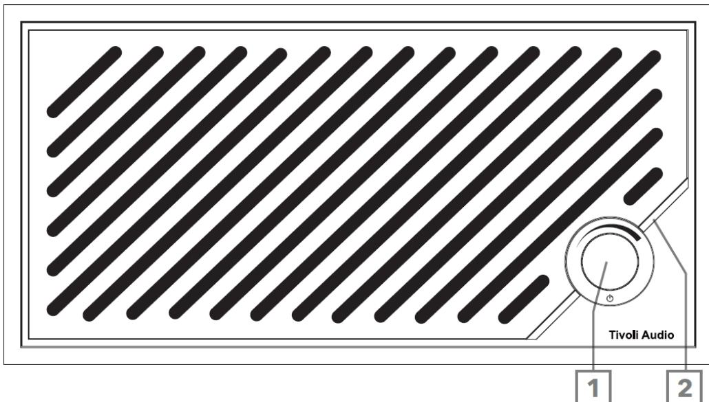
1. 電源/ソース/音量ノブ: 短く押すと電源が入り、長押しすると電源が切れます。短く押すと、Wi-Fi、Bluetooth、Aux In ソースが切り替わります。右に回すと音量が上がり、左に回すと音量が下がります。
