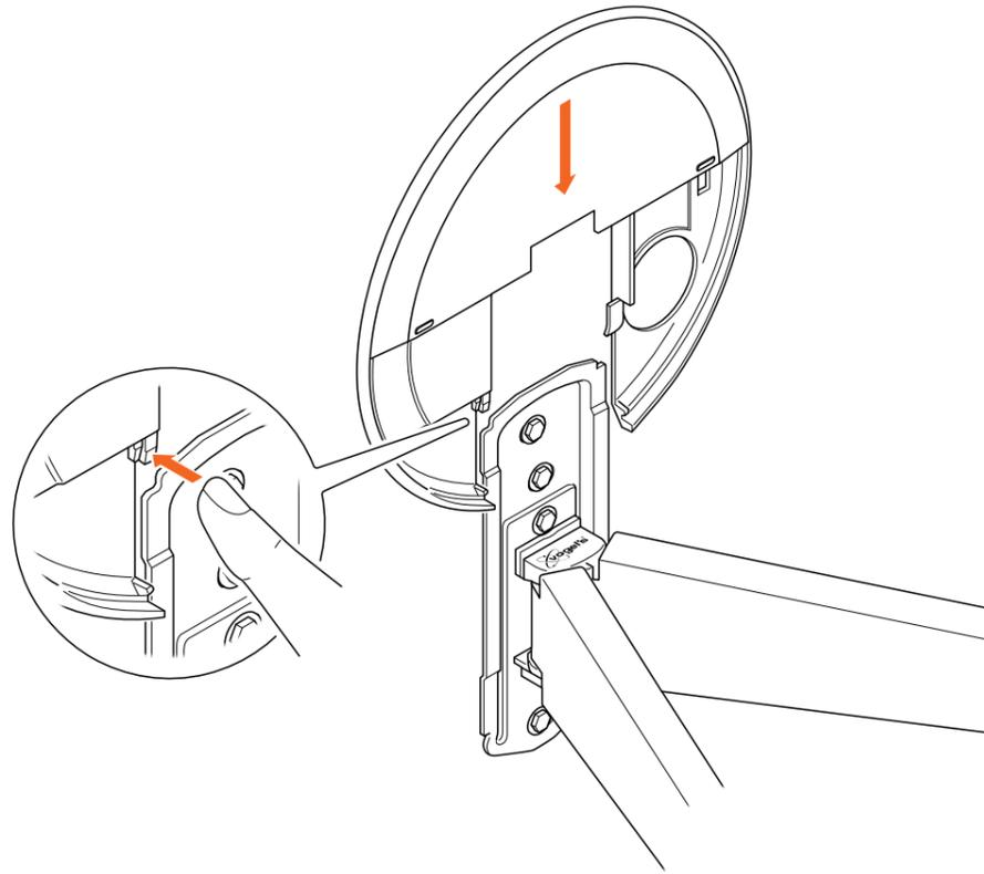
5. Schieben Sie die **Abdeckung der Wandplatte** ④ auf die **Wandhalterung** ④. Um die Abdeckplatte zu entfernen, drücken Sie auf die linke Lasche und schieben Sie sie von der Wandhalterung.
