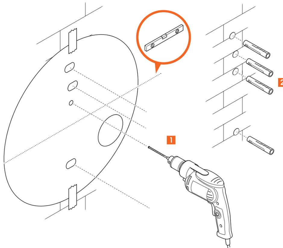
2. Bohren Sie die Löcher. Achten Sie darauf, dass Sie zuerst das Positionierungsloch bohren. Bohren Sie mit einem kleineren Bohrer vor, um Schäden an der Wand zu vermeiden.
