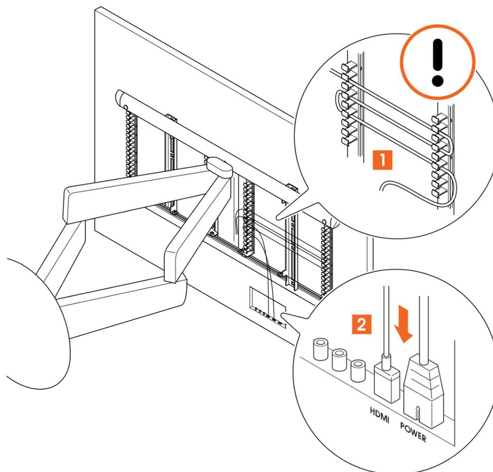
5. Schließen Sie das Netzkabel und das **HDMI 2.0-Kabel (2 Meter)** an den Fernseher an.
