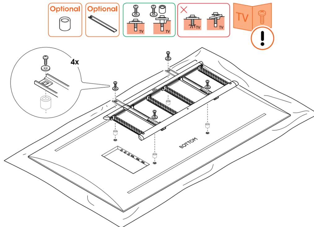
5. Schrauben Sie den **Adapter** mit den **Bolzen** ⑥ und **Abstandhaltern** ⑦ an den Fernseher. Vergewissern Sie sich, dass die Oberseite des Rahmens richtig positioniert ist, was durch das Wort „top“ auf dem **Adapter** angezeigt wird.
