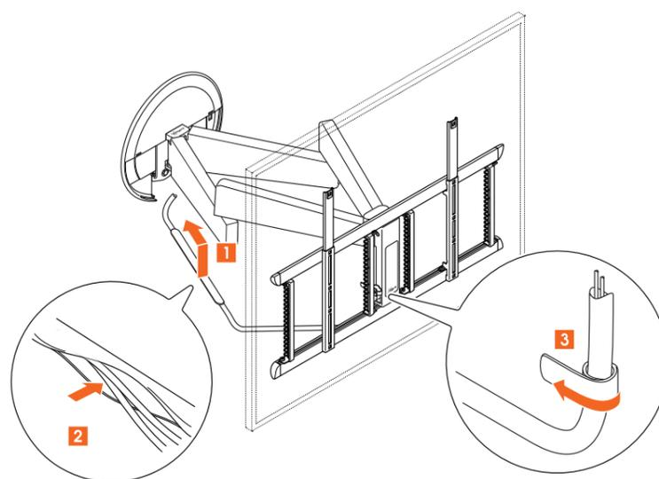
1. Befestigen Sie die **Kabelschutzhülle** ① an der **Wandhalterung** ②, indem Sie sie in die Löcher an der Unterseite des rechten Arms schieben.
