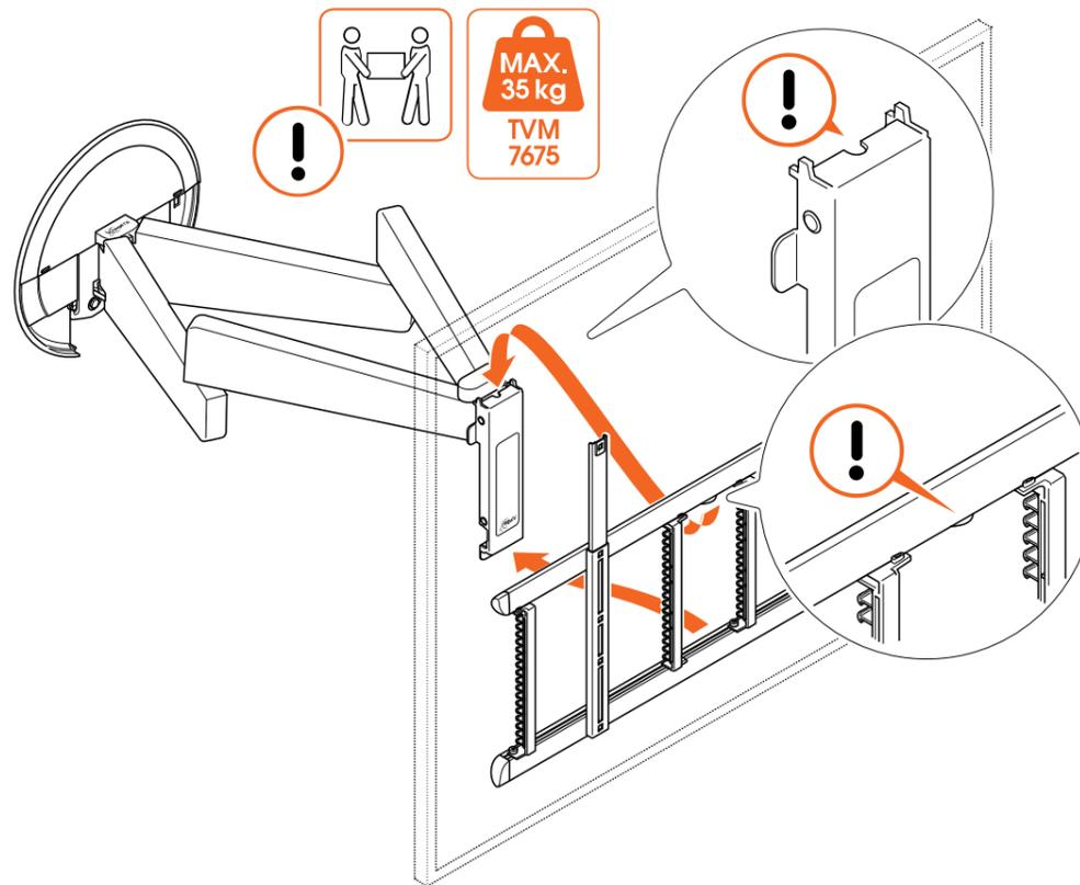
1. Heben Sie den Fernseher vorsichtig an und befestigen Sie ihn auf der Adapterhalterung an der **Wandhalterung** ④. Achten Sie darauf, dass der Stecker des Adapters in die Aussparung der Wandhalterung passt.
