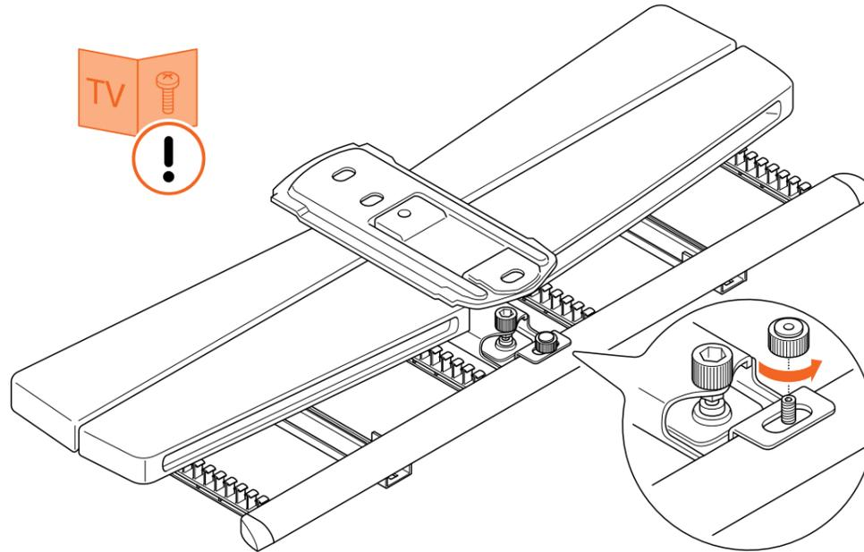
2. Entfernen Sie die **Flügelmutter** und nehmen Sie die **Wandhalterung** <sup>Ⓐ</sup> vom **Adapter** ab. Bewahren Sie die **Flügelmutter** zur späteren Verwendung auf.
