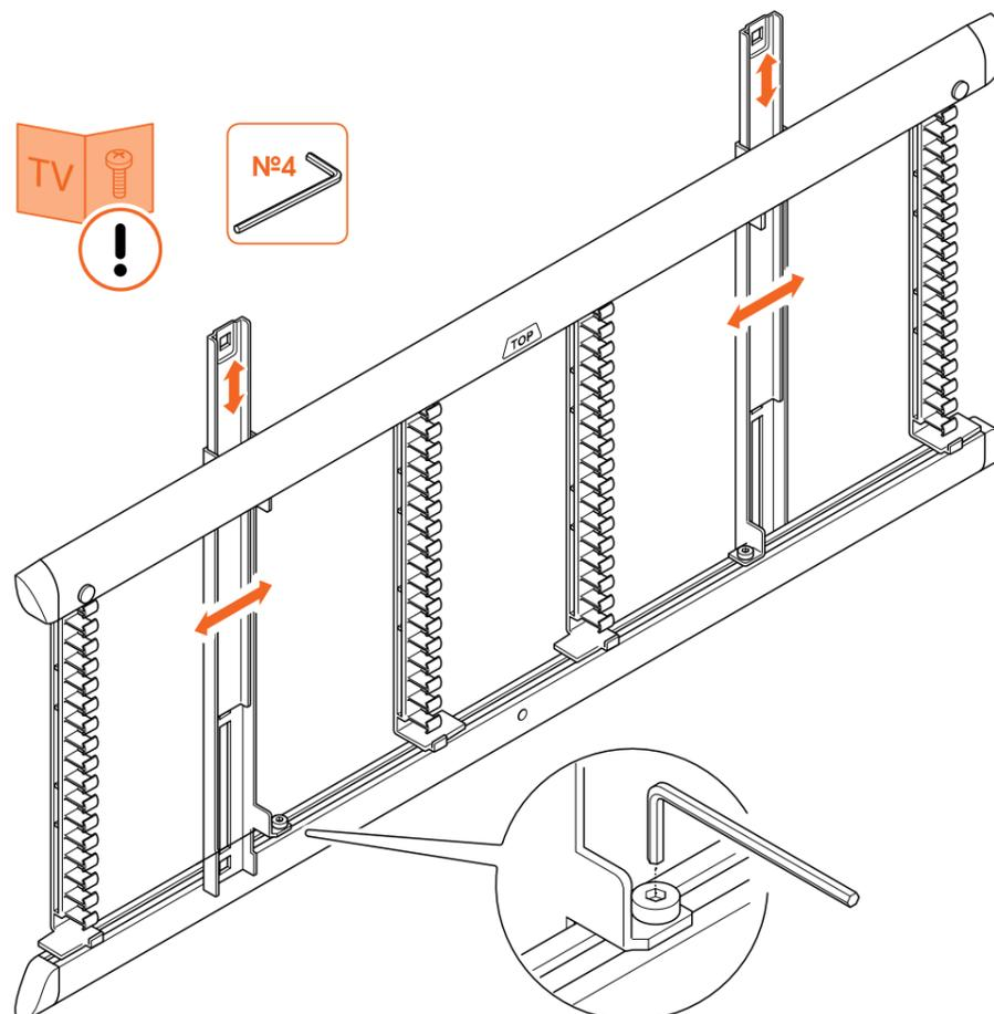
3. Überprüfen Sie die Befestigungslöcher am Fernsehbildschirm. Passen Sie die Abmessungen des **Adapters** entsprechend an, nachdem Sie die **vormontierten Schrauben** mit dem **Inbusschlüssel** gelöst haben.
