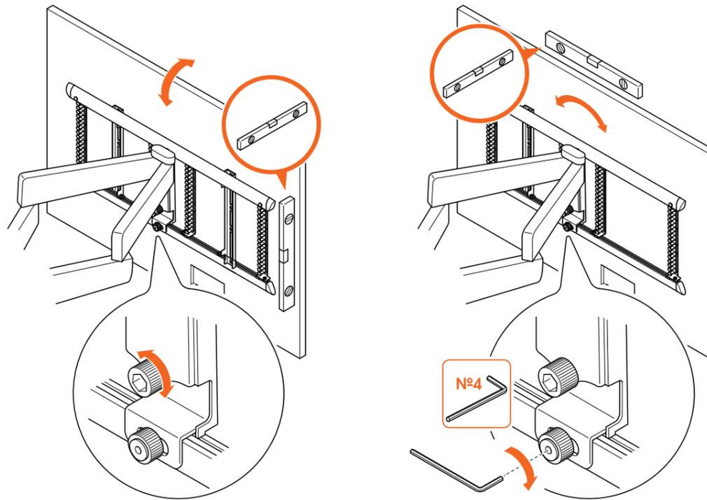
3. Nivellieren Sie die **Wandhalterung** und den Fernsehbildschirm. Verwenden Sie eine Wasserwaage und den **Inbusschlüssel**, um die Position zu korrigieren. Ziehen Sie die **Flügelmutter** und die **Flügelbolzen** anschließend mit dem **Inbusschlüssel** fest.
