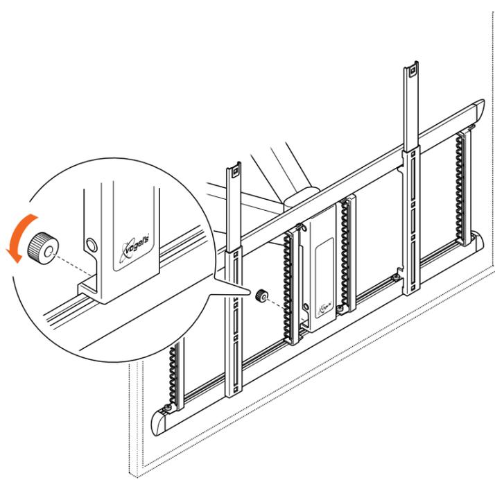
2. Befestigen Sie den Adapter mit der gesicherten **Flügelmutter** aus Schritt 1 an der **Wandhalterung**.
