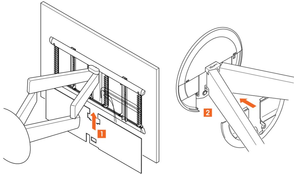
6. Setzen Sie die **Wandplattenabdeckung** ☉ auf die Wandhalterung und die **Adapterabdeckung** ☉ auf die Rückseite des **Adapters**.
