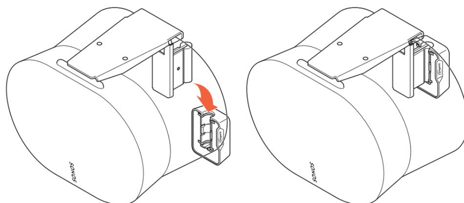
1. Soulevez l'enceinte et insérez le **module d'inclinaison** ① dans le **support mural** ②.
