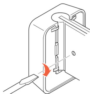
3. Fixez l'enceinte en serrant la vis de pression sur le côté du **module d'inclinaison** ①.
