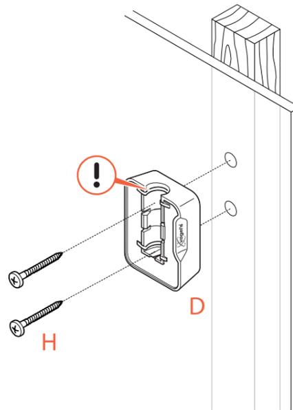
6. Fixez le **support mural** ① au mur à l'aide des **vis** ②. Utilisez le niveau à bulle intégré pour incliner le **support mural** ① jusqu'à ce qu'il soit de niveau.
