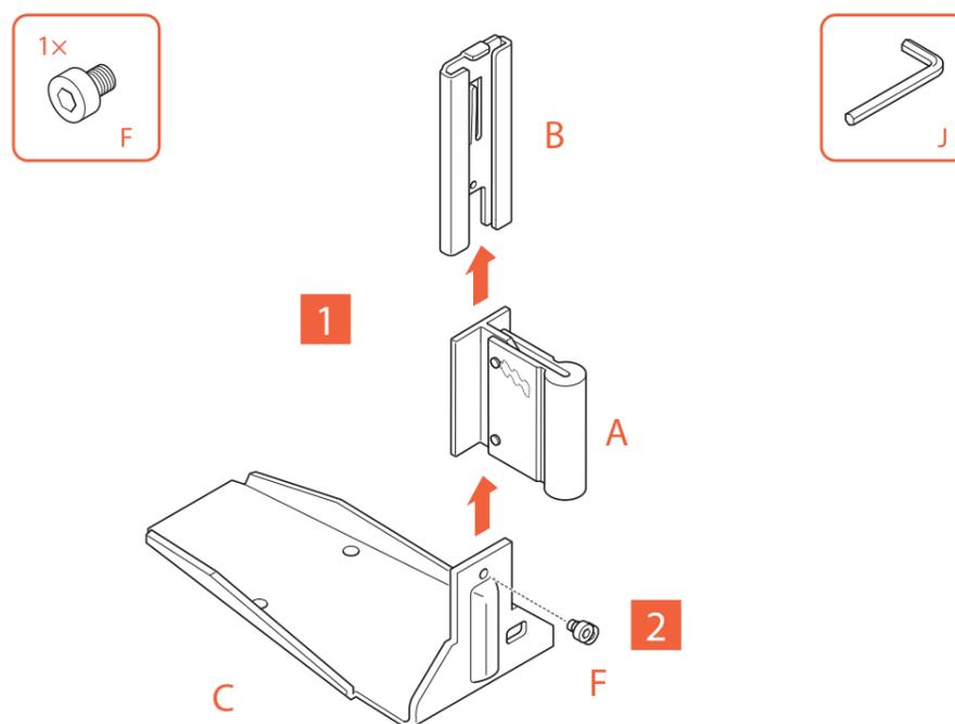
1. Glissez le **module d'inclinaison** © et le **support d'enceinte** Ⓐ dans le **support d'inclinaison** Ⓑ.
