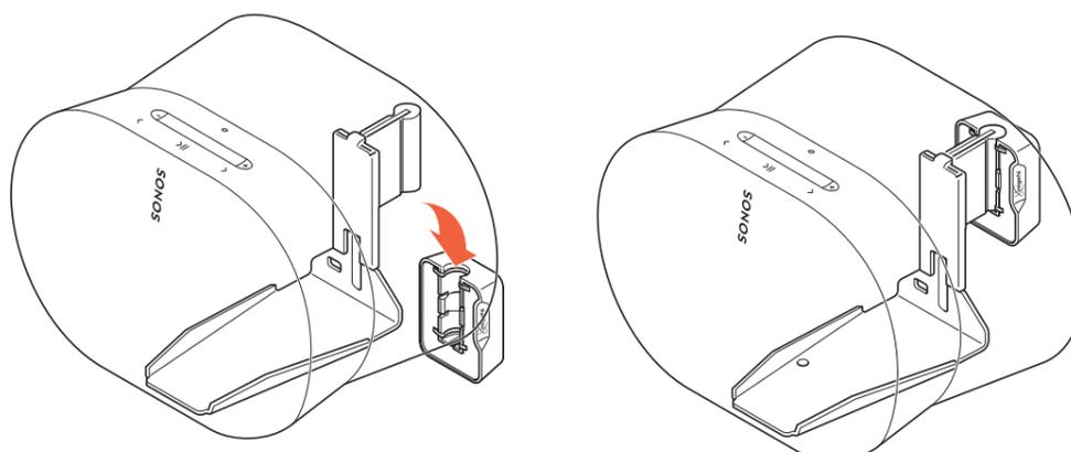
1. Soulevez l'enceinte et insérez le **module d'inclinaison** ④ dans le **support mural** ⑤.
