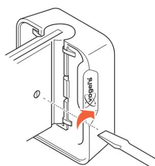
3. Fixez l'enceinte en serrant la vis de pression sur le côté du **module d'inclinaison** ④.
