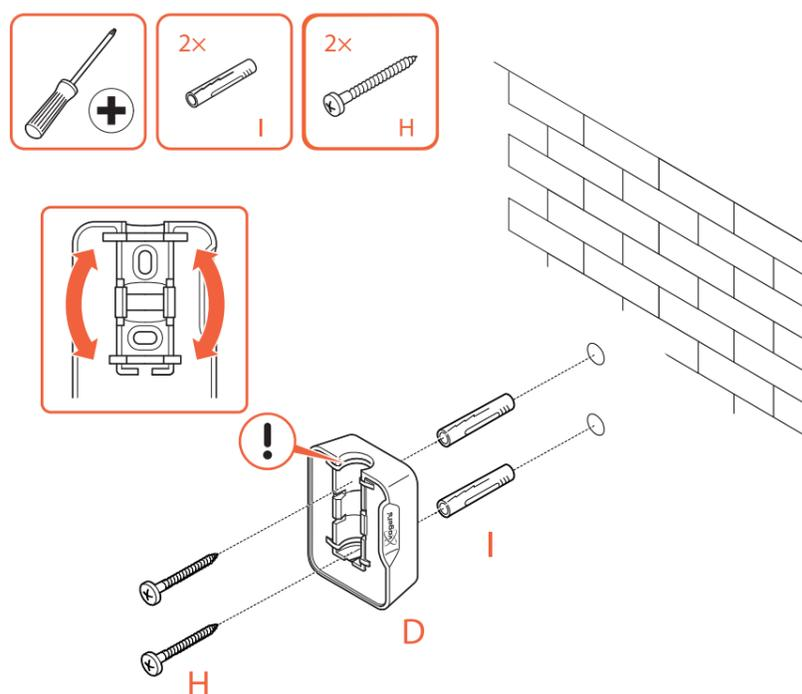
5. Fixez le **support mural** ⑤ au mur avec les **vis** ④ et les **chevilles** ①. Utilisez le niveau à bulle intégré pour incliner le **support mural** ⑤ jusqu'à ce qu'il soit de niveau.
